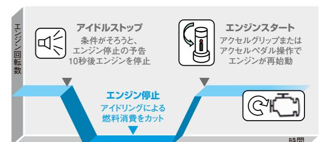
省エネと排出ガス低減に役立つ、オートアイドルストップ機能を新搭載。作業中の無駄なアイドリングを防止し、燃費低減や部品消耗の抑制に貢献します。スイッチONで条件が整った場合にエンジンを停止、アクセル操作でエンジンが再始動するため、作業も妨げません。
