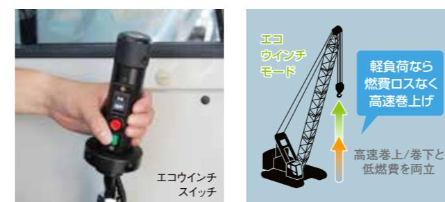
軽負荷時にエンジン低回転のまま、ハイスピードの巻上げ、巻下げを可能にするエコウインチモードを新搭載。高揚程の建設現場やロープ掛け数の多い作業などの際に、すぐれた作業効率を発揮、またエンジン回転数を抑えることで、燃費ロスや騒音も低減します。
